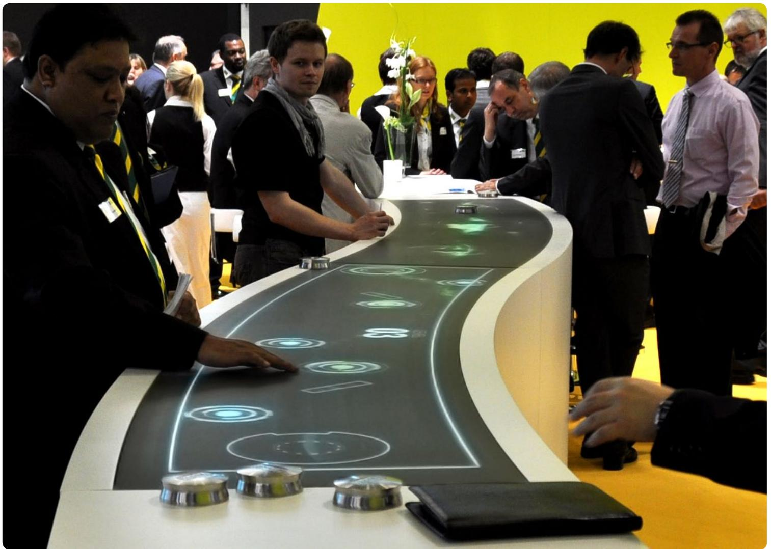
Der interaktive Tresen wurde mit insgesamt sechs MultiTOUCH-Modulen von eyefactive zum Leben erweckt. Durch eine spezielle Anordnung der Module und der flexiblen Tracking-Engine EVOVIS entstand erstmals ein S-förmiges Display.
